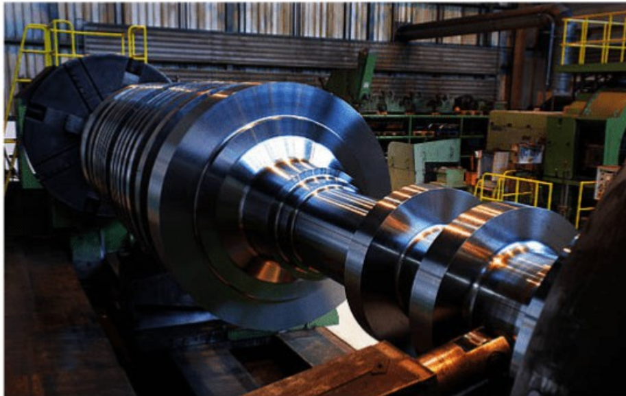
Beispiel für eine Welle für den Einsatz für einem Turbosatz für konventionelle Kraftwerke
